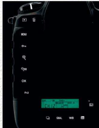
상단 컨트롤 패널, 후면 제어판과 함께, 릴리즈 모드 다이얼, 바디 후면 및 왼쪽 상단의 주요 버튼의 아이콘 표시를 백라이트로 확인할 수 있습니다. 새롭게 재생 버튼, 삭제 버튼에도 채용하였습니다. 어두운 곳에서 촬영할 때에도, 조작계의 시인성을 향상하여 자연스럽게 조작이 가능합니다.
